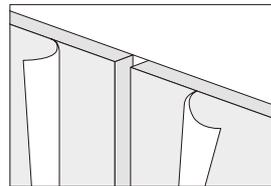
マスキングテープを貼り付ける部分のみ、表面の保護フィルムを剥がしておきます。
